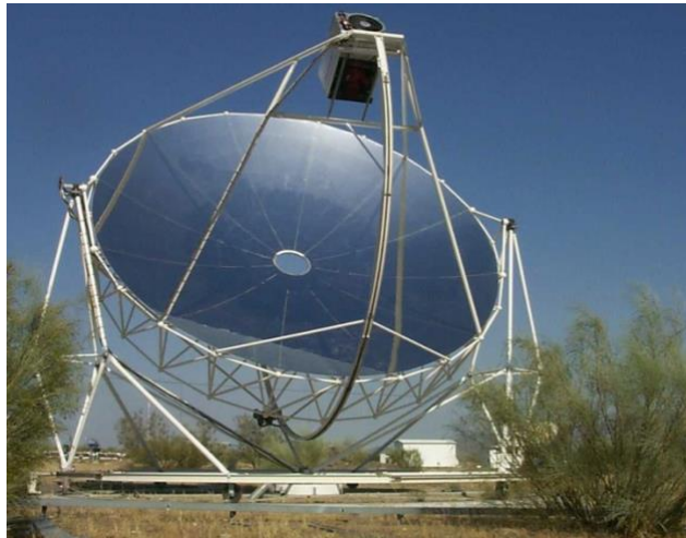
Figura 5: Solare termodinamico a specchio parabolico
